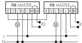
Agrandissement de la zone de détection avec un ou plusieurs appareils Slave. L'appareil Master doit toujours être monté à l'endroit où la quantité de lumière est la plus faible.
