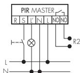
La lumière peut être allumée ou éteinte manuellement en fonction des besoins en fonction des besoins grâce à la commande à poussoir (Attention: les boutons poussoir lumineux sans neutre ne peuvent pas être gérés).
